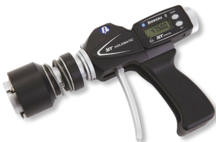
Digital-Innen-Schnellmessgerät für Bremsattel-Nutmessung.
